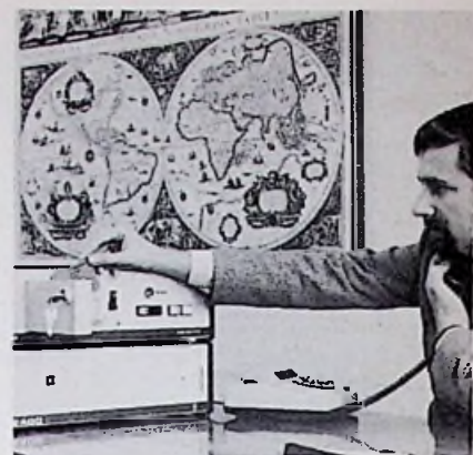
Afb. 5. In de kanaalvocoder wordt gesproken tekst gedigitaliseerd met opdeling in vele frequentiekanalen.
