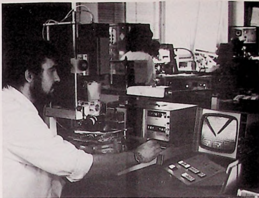
Afb. 17. Beproevingen van MOS-FET's in-wording d.m.v. een computer gestuurde chip-moet-automaat, ontwikkeld door AEG-Telefunken en in bedrijf in de halfgeleider fabriek in Heilbron.
