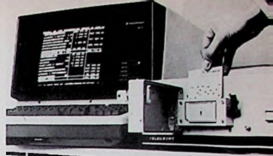
Afb. 7. Codering en decodering kan slechts plaatsvinden met éénzelfde of identieke kaart bij in- of uitgang van de computerlijn.
