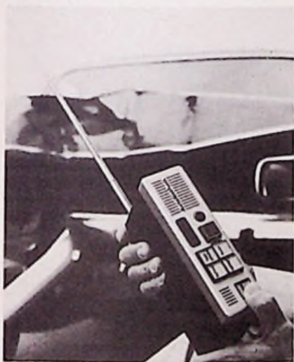
Afb. 18. Nood-alarm radio voor automobilisten.
